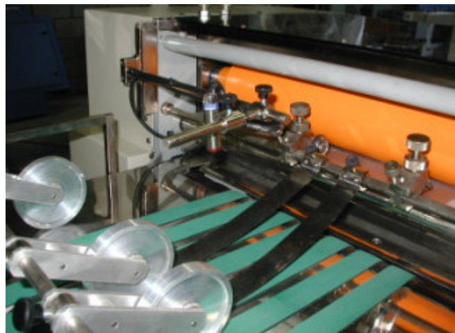
Mesa de Saída e Roldanas para o papel após passagem pela faca
